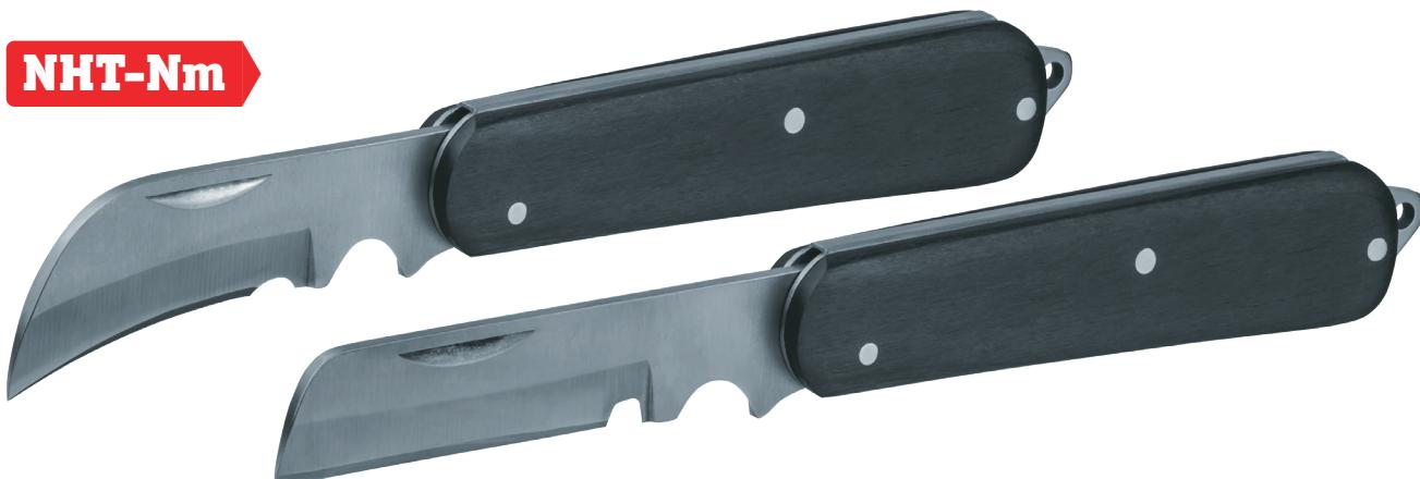
**Монтерские складные ножи NHT-Nm01/02** предназначены для снятия бумажной и ПВХ-изоляции с кабеля, зачистки жил от окисной пленки, поперечной и продольной резки изоляции. Острое лезвие из нержавеющей стали с двухсторонней заточкой имеет две дополнительные выемки разного диаметра для поперечного снятия изоляции.
